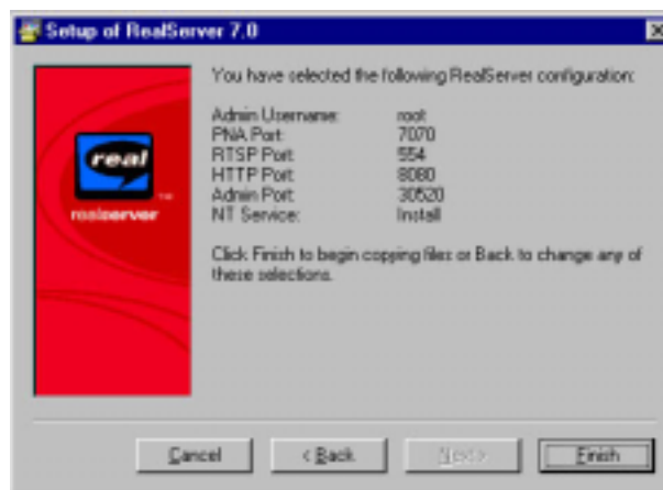
Figure 8 : Récapitulatif de l'installation de RealServer 7.0
